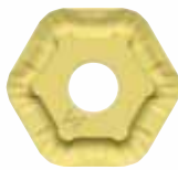
HNHX0905ANSNGE- Neue Schruppgeometrie mit integrierter Planfase für verbesserte Oberflächengüte
