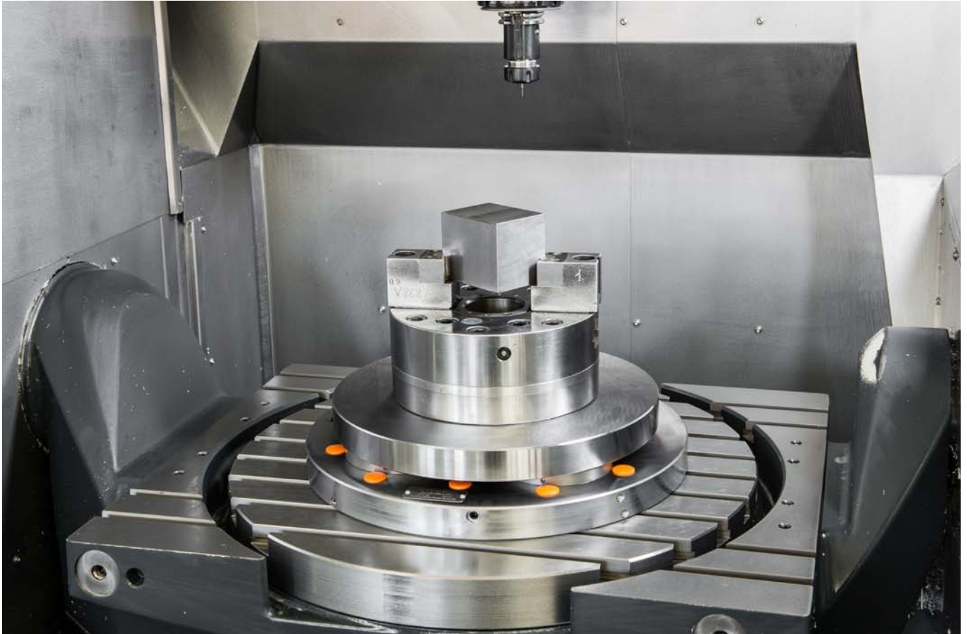
4-fach-Spannstation mit integrierter Auflagen- sowie direkter Verriegelungskontrolle für den Einsatz auf Fräs-Drehmaschinen bis zu einer maximalen Drehzahl 2200 U/min.
