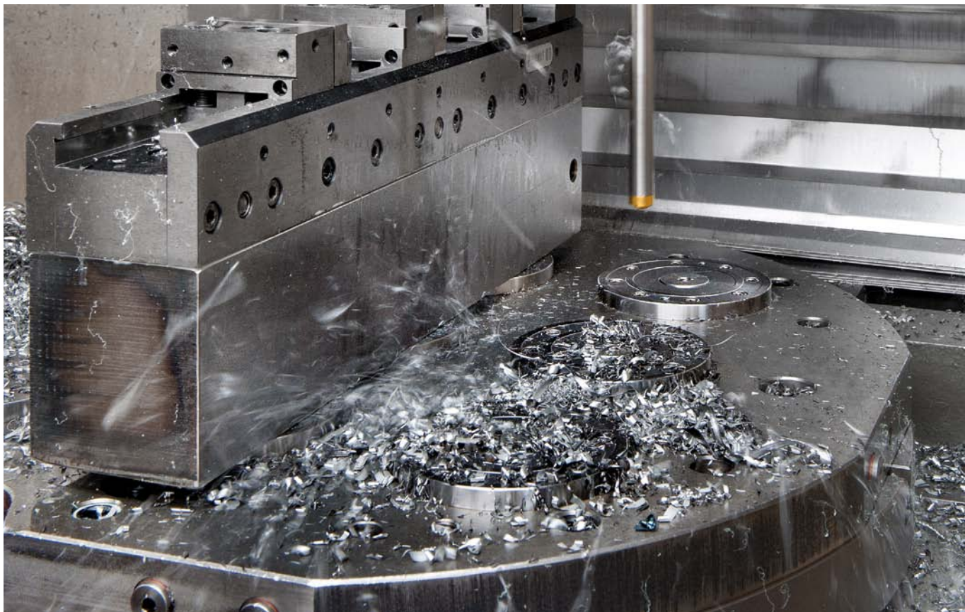
AMF-Clean-Stick im Einsatz: Automatisierte Reinigung von Spannvorrichtung und Maschinentisch.
