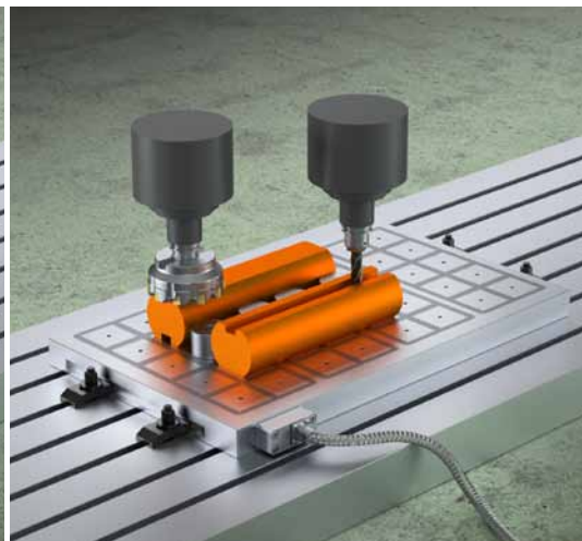
Fräsen von Flächen und Nuten an Rundmaterial
