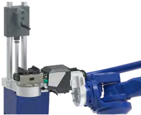
Der Schraubstock für OP20 wird eingelegt The vise for OP20 is inserted
