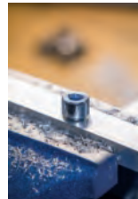
Repariertes Gewinde = höhere Belastbarkeit
