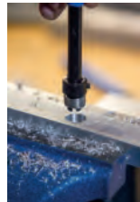
Schritt 3: Einbau des Gewindeeinsatzes
